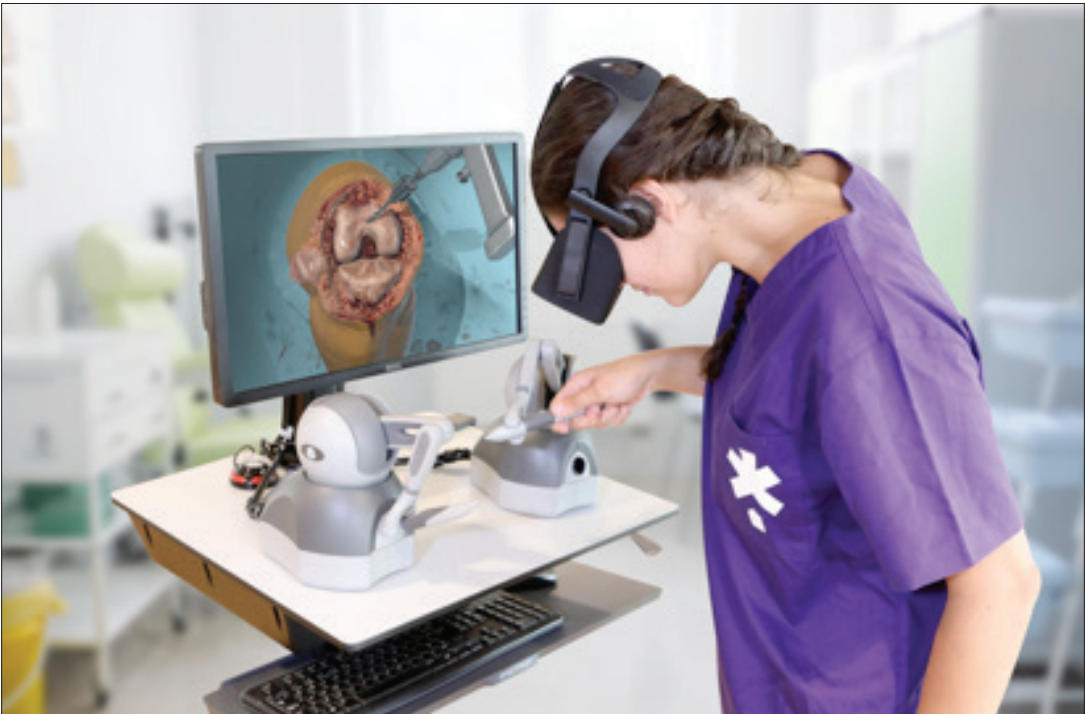
Şekil 3. 3D Systems tarafından geliştirilen The Touch haptics cihazı, kullanıcıların ellerine kuvvet geri bildirimini uygulayan, sanal nesnelere hissetmelerine olanak tanıyan ve kullanıcılar ekrandaki 3D nesnelere yönetirken gerçekçi dokunma hisleri üreten motorlu bir cihazdır (Kaynak: 3D Systems).
