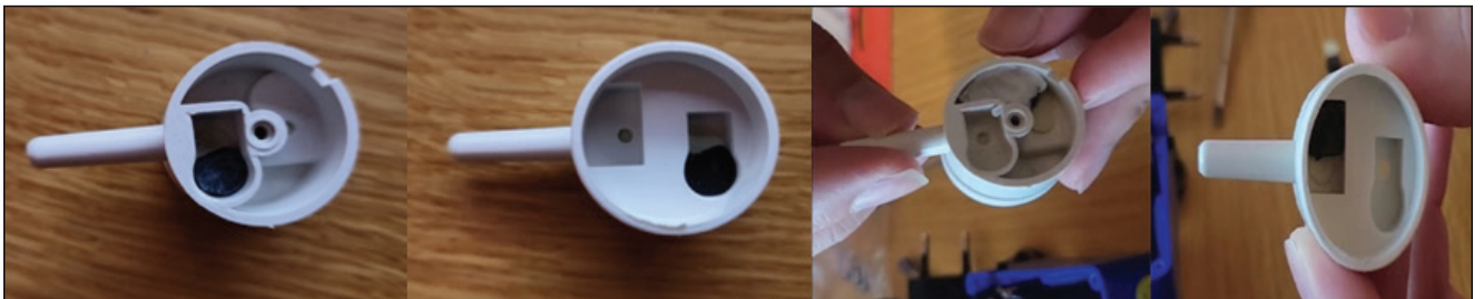
Şekil 2. Akvaryum motorunun körük odasındaki kapakçıkların yerleşimi ve negatif basınç yapması için yerlerinin değiştirilerek sabitlenmiş hali.
