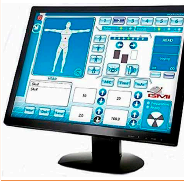
Şekil 11. Sanal bölge ayarı. Floroskopi cihazı en uygun dozda en iyi görüntüyü sağlamak için otomatik olarak programlanır.
