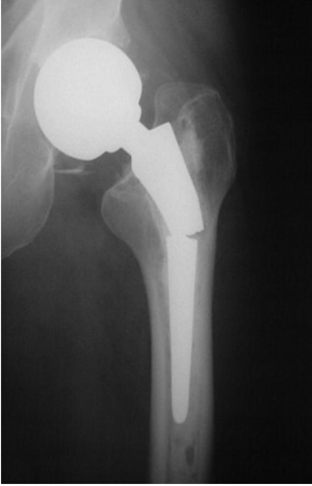
Şekil 15. Metal yorgunluğuna bağlı kırılmış femoral komponent.
