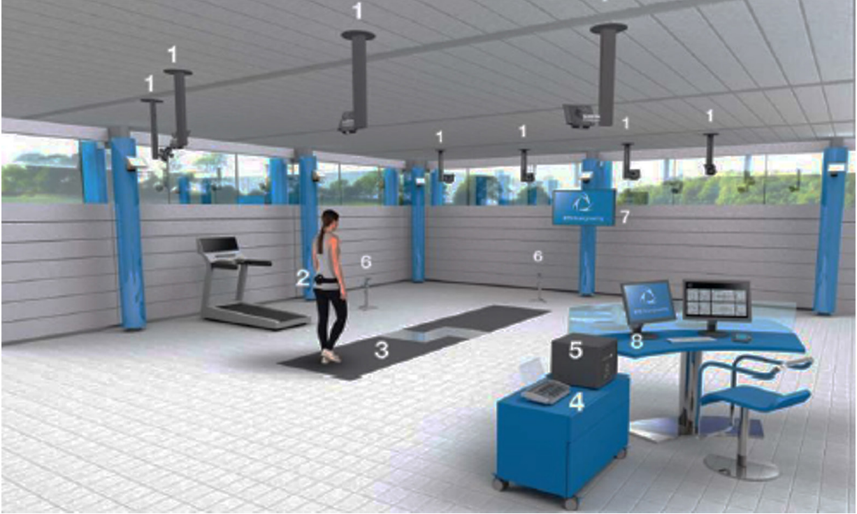
Şekil 6. BTS Yürüme Laboratuvarı kurulumu; kızılötesi video kameralar (1), eylemsizlik sensörleri (2), YTK yürüme yolu ölçümü (3), kablosuz EMG (4), çalışma yeri (5), video kayıt sistemleri (6) ve TV ekranı (7).
