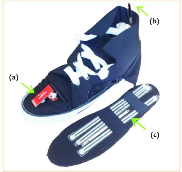
Şekil 4. a–c. Smartxa Projesi'nden aletli ayakkabı: eylemsizlik ölçüm birimi (a); esnek açölçer (b) ve iç tabanın içinde yer alan basınç sensörleri (c).
