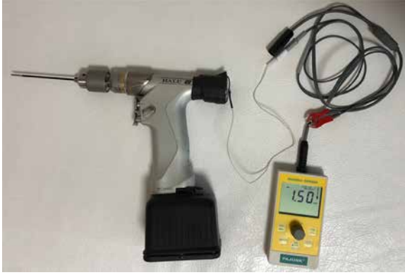
Şekil 6. Prototip görseli; sinir stimülatörü, kablo devresi, sinir iletimine uyarlanmış delici motor, dışı yalıtılmış sinir uyarıcı K-teli birlikte görülüyor.
