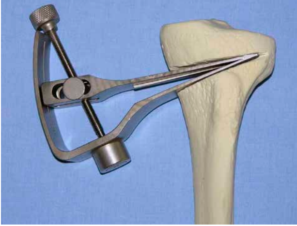
Şekil 10. Şekil 4 ve 5'te teknik resim çizimleri verilen açılı göstermeli distraktörün plastik kemik model üzerinde uygulanmış görünümüdür.
