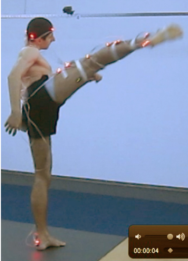
Şekil 13. Kuvvet platformu ve hızlı kameralar kullanarak laboratuvarında tekvando vuruşunun ölçülmesi.
