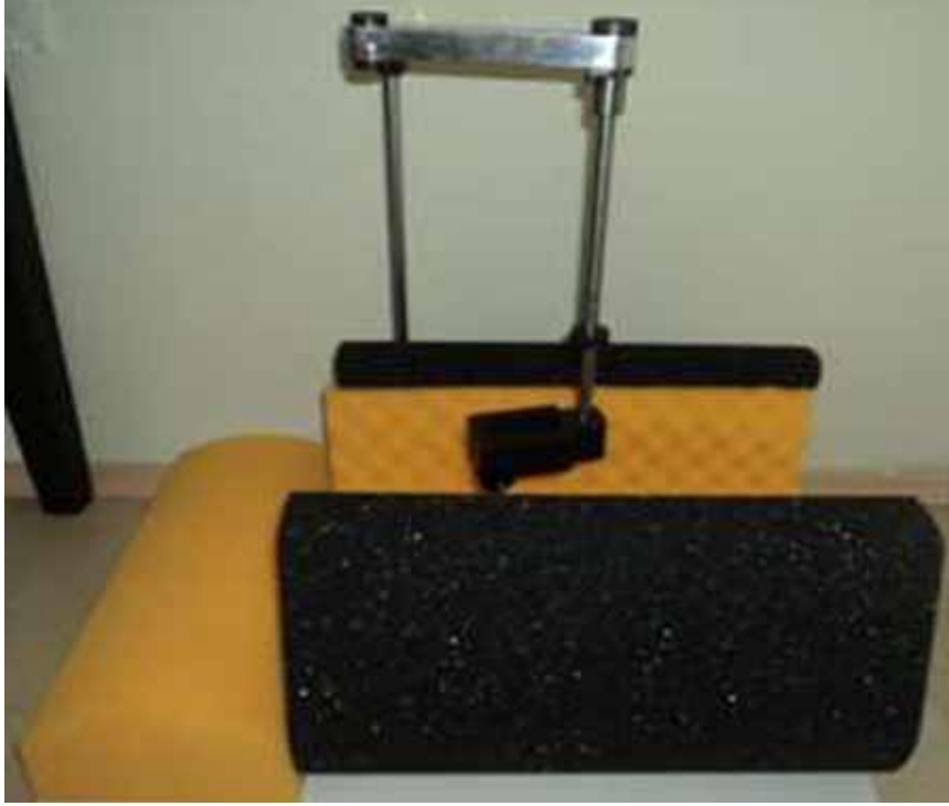
Şekil 1. Kalça US masası ve prob tutucu.
