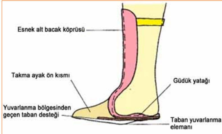
Şekil 6. Chopart amputasyonunda yürüme desteği AFO.
