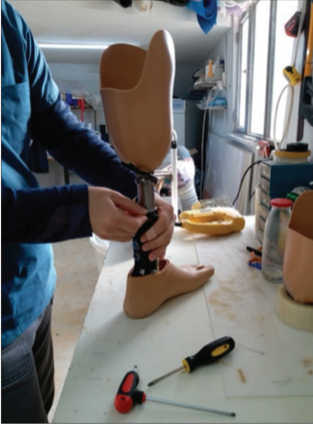
Şekil 3. Tüm protezlerde hasta üzerinde denge, açı ayarlamaları yapılır. Ancak daha öncesinde montaj yapılırken ön ayarlama yapılmalıdır.
