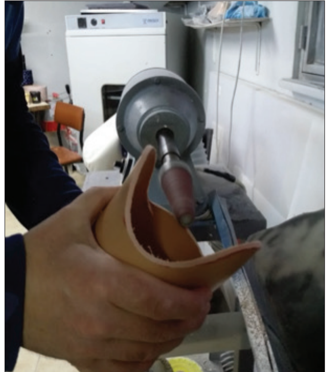
Şekil 2. Yapılan soket, freze yardımıyla modifiye edilerek soket montaja hazırlanır.
