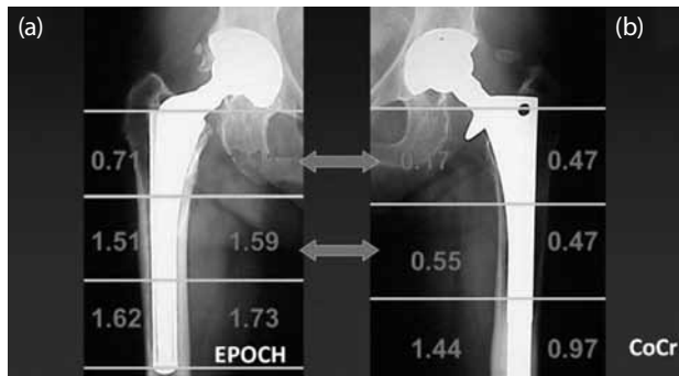
Şekil 8. (a) Elastik stemlerde kemik yoğunluğunda artış. Rakamlar kemik mineral yoğunluğunu belirtiyor. Merkezi kobalt-krom alaşım, yüzey kaplaması gözenekli titanyum olan ve elastikiyeti kemiğe yakın (extensively porous coated hip replacement; EPOCH) stemler. (b) Tümü kemikten çok daha sert olan kobalt-krom alaşımdan yapılmış Co-Cr stem ve etrafında kemik yoğunluk kaybı.
