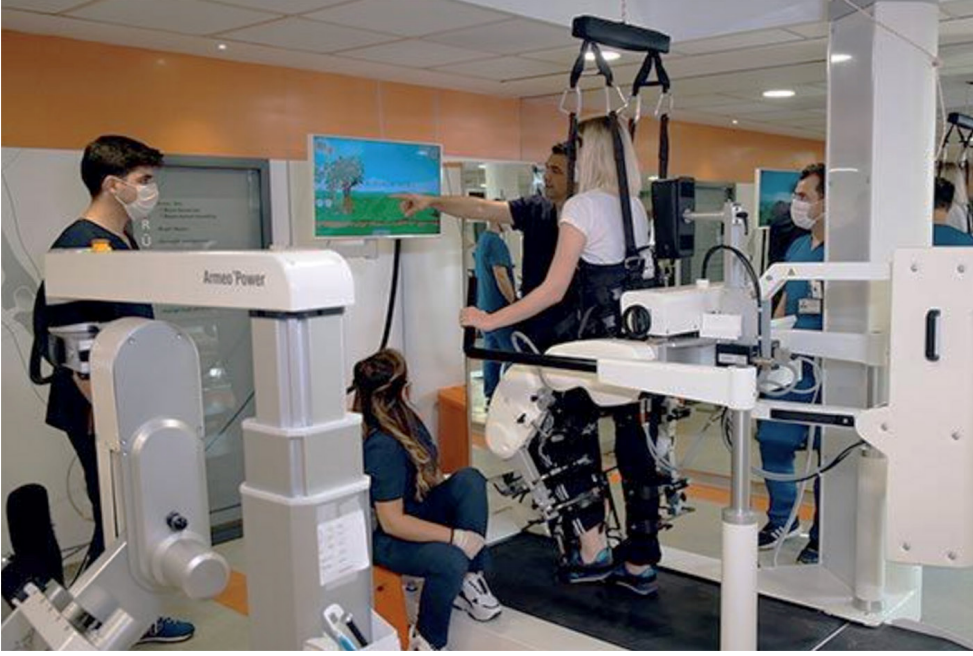
Şekil 3. Yürüme eğitimi yapan, kliniklerde kullanılabilen sabit yürüme robotları.
