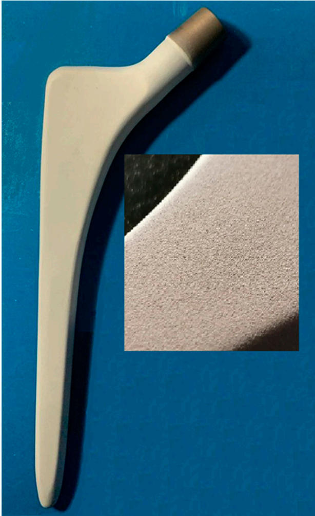
Şekil 4. Gümüş iyon katkılı seramik ile kaplanmış kalça protez sapı.
