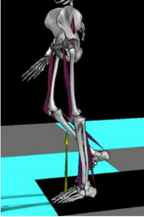
Şekil 2. Kuvvet plağı sayesinde elde edilen yer tepkime vektörü (sarı ok).
